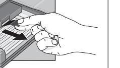
6 Schieben Sie die neue Festplatte in das Gerät, und bringen Sie die Befestigungsschraube wieder an der Unterseite des Geräts an.
