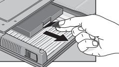
6 Inserte la nueva unidad de disco en la unidad y sustituya el tornillo de bloqueo de la parte inferior de la unidad.
