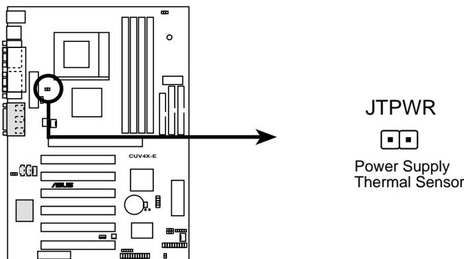
**CUV4X-E Thermal Sensor Connector**
