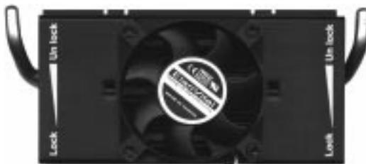
ファン付きElan Vitalヒートシンクのインストール手順は、ファンなしヒートシンクと同じです。しかし、Elan Vitalヒートシンクは、レバーでヒートシンクをSECカードリッジに締めつけます。ヒートシンクを正しく装着し、レバーをロックします。ファンがあるためにヒートシンクサポートトップバーを利用することができません。ヒートシンクサポートトップバーは、ファンなしでヒートシンクを使う場合のために付属しています。
