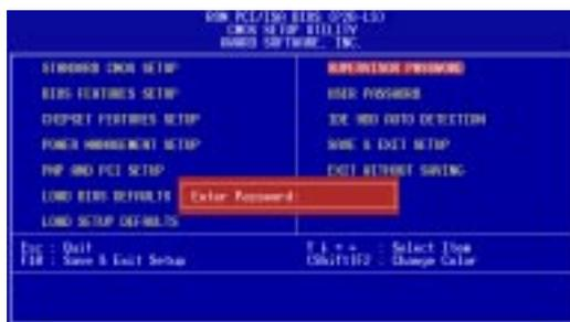
パスワードによる保護を有効にするために、BIOS Features Setup 画面の Security Option で、システムがいつパスワードの入力を求めてくるかを指定してください。パスワードを無効にしたいならば、Enter Password プロンプトが表示されたとき、新しいパスワードを入力する代わりに<Enter>キーを押します。そのパスワードが使用禁止にされたことを確認するメッセージが表示されます。
