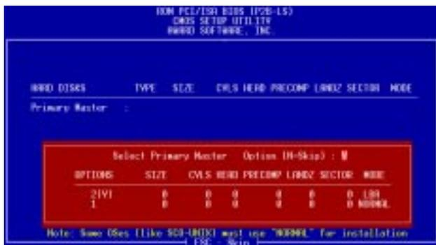
最高4台のIDEドライブを検出することができ、それぞれのパラメータをボックスに順に表示します。最適値を入力するためには<Y>キーを押します。そうでない場合は、設定項目の下に表示された数値を選択します。このドライブをとばして次のドライブに進むためには<N>キーを押します。<Y>キーを押せば、パラメータはドライブ名の横に表示され、次のドライブ名へ進みます。<N>キーを押した場合、そのドライブ名の後にゼロが表示されます。
