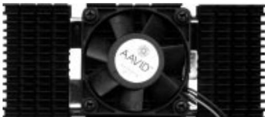
ファン付きAAVIDヒートシンクのインストール手順は、ファンなしヒートシンクのインストール手順に類似しています。しかし、ファンがあるためヒートシンクサポートトップバーを使うことができません。ヒートシンクサポートトップバーは、ファンなしでヒートシンクを使う場合のために付属しています。
