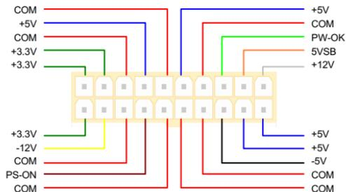
**警告：** 在 ATX 系統的主機板上會常有一待機電流存在。請確定把 ATX 電源連接線拔離 ATX 電源接頭才可插裝或移除 CPU、DIMM、PCI 及 AGP 卡等。否則元件會受到嚴重傷害。
