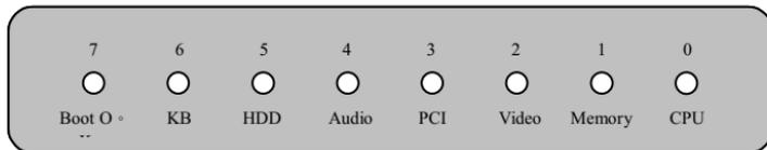
這 8 個指示燈將會在開機過程中分別閃爍，當第 7 個(最後一個)亮起時表示電腦已完成了整個開機的程序。
