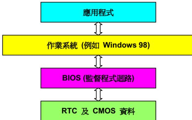
在 BIOS 程式中有一個程式迴路不斷地紀錄時間與日期的資料(大約每 0.05 秒循環一次)，在一般的 BIOS 中這個程式迴路並不會每次去更新 CMOS 的時間資料。因為 CMOS 是一個較慢的裝置，這樣會影響電腦效率。在我們所研發的 BIOS 中使用了 4 位數處理年份，然後作業系統與應用程式就會取得正確的日期與時間的資料。所以使用我們的產品 Y2K 的問題是不存在的(已通過 NSTL 測試)，(不幸地有些 Y2K 測試程式如 Chekit 98 卻直接去讀取 RTC/CMOS 資料)。本主機板具備硬體 Y2K 檢查及保護，以確保執行安全作業。
