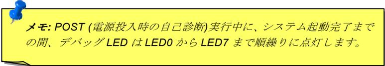
**メモ:** POST (電源投入時の自己診断)実行中に、システム起動完了までの間、デバッグ LED は LED0 から LED7 まで順繰りに点灯します。
