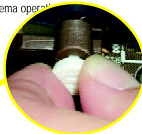
Extraiga con cuidado la pequeña barra blanca de plástico situada al final del zócalo AGP cuando intente instalar/desinstalar la tarjeta AGP. Alinee la tarjeta AGP con el zócalo AGP en placa y apriete firmemente hacia el zócalo. Asegúrese de que la tarjeta AGP queda correctamente sujeta con la pequeña barra blanca de plástico.
