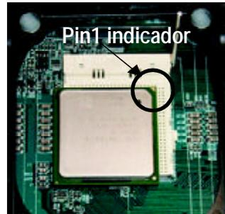
1. Tire hacia arriba de la palanca del zócalo de CPU hasta formar un ángulo de 90 grados.
