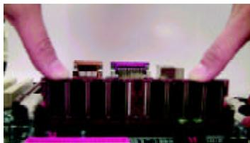
1. El banco DIMM incluye una muesca, para que el módulo DIMM de memoria sólo puede ajustar en una dirección.
