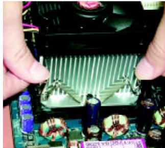
1. Apriete la base del disipador de calor en el zócalo de la CPU en la Placa base.
