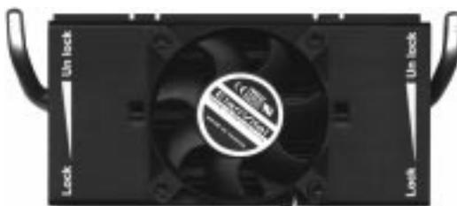
ファン付き Elan Vita ヒートシンクのインストール手順はファンなしヒートシンクと同じです。しかし、Elan Vita ヒートシンクは、レバーでヒートシンクを SEC カートリッジに締めつけます。ヒートシンクを正しく装着し、レバーをロックします。ファンがあるためにヒートシンクサポートバーを利用することができません。ヒートシンクサポートトップバーは、ファンなしでヒートシンクを使う場合のために付属しています。
