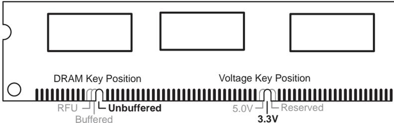
DIMM モジュールタイプを確認できるように、刻み目が左、中央、右にシフトしています。このことで、マザーボード上の DIMM スロットに異なるタイプのモジュールを挿入しないように確認することができます。購入する前に販売店で仕様を確認してください。このマザーボードでは、4クロックシグナルをサポートしています。
