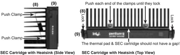
3. SECカートリッジを挿入します：SECカートリッジの2つのロックを内側に押し込みます(下の図はロックの位置を示しています)。ヒートシンクがボード上のチップセットの方を向くようにして、カートリッジをしっかりと押し込みます。
