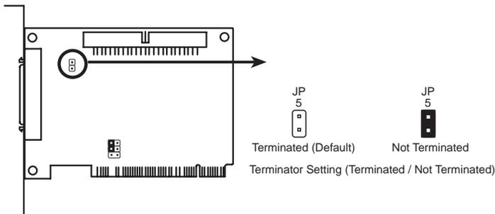
SCSI機器は、接続されている位置によりターミネータの設定をします。終端の機器だけはターミネートする必要があります。接続している機器が内部接続、または外部接続でも1つの機器だけを接続している場合は、ASUS PCI-SC200をターミネータにしなければなりません。内部接続と外部接続の機器を使用する場合、カードをターミネータとして設定してはいけません。接続と設定について以下の例を参照してください。
