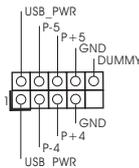
**Infrared Module Header**
