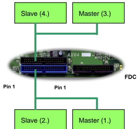
IDE1 wird auch als der primäre Kanal und IDE2 der sekundäre Kanal genannt. Jeder Kanal unterstützt zwei IDE-Geräte; insgesamt vier Geräte. Um zusammenarbeiten zu können, müssen die beiden Geräte auf jedem Kanal auf **Master-** bzw. **Slave-**Modus gestellt werden. Beide können auf Festplatte oder CDROM eingestellt werden. Die Einstellung als Master- oder Slave-Modus hängt von dem Jumper auf Ihrem IDE-Gerät ab, schauen Sie also bitte im Handbuch Ihrer Festplatte bzw. CDROM nach.
