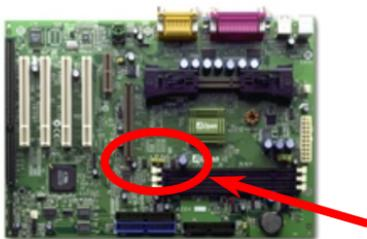
Dieser Jumper wird zur Synchronisation des Verhältnisses von PCI und dem [FSB](#)-Takt verwendet. Wir empfehlen die Voreinstellungen, wenn Sie nicht gerade übertakten.
