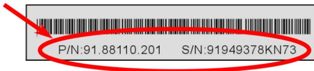
**P/N: 91.88110.201** ist die Teilenummer, **S/N: 91949378KN73** ist die Seriennummer.
