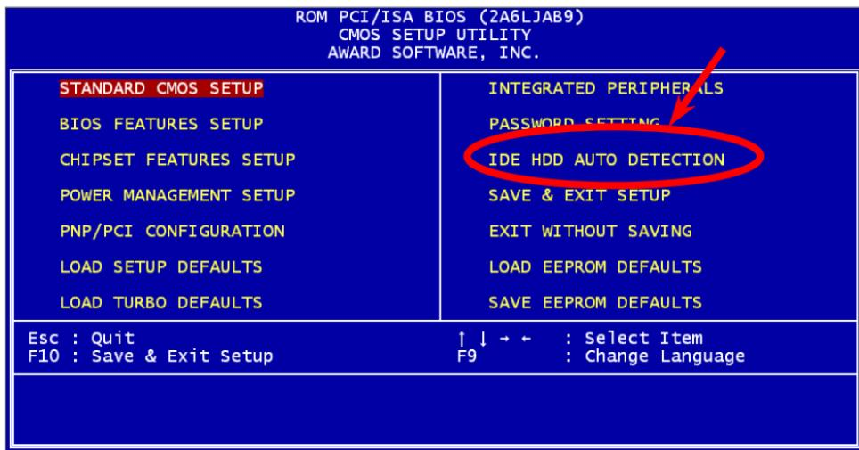
這項自動偵測功能僅會提供一組適合您硬碟機的參數值，如果您的硬碟是用不同的參數所格式化，您必須自行輸入參數值，當設定參數與硬碟實際參數不同時，您將可能無法讀取硬碟上的資料，所以當所偵測的參數值與實際硬碟參數值不同時，請輸入 N，以拒絕使用該值，然後從"Standard CMOS Setup"中自行設定正確值。
