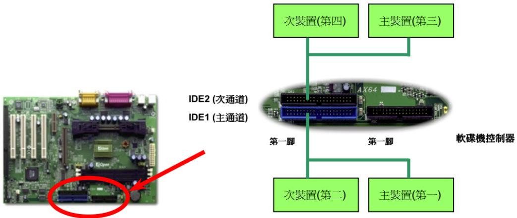
IDE1 也可以用主通道(primary channel)表示，IDE2 也可以用次通道(secondary channel)表示，每一通道可以支援 2 個 IDE 裝置，所以兩個通道一共就可以支援 4 個 IDE 裝置；由於同一通道上裝置都連接在同一條排線上，所以裝置必須依設定區分成主裝置(master)和次裝置(slave)的不同。任何一個 IDE 裝置可以是一台硬碟機或是光碟機，至於該裝置是主裝置(master)或是次裝置(slave)就依照該裝置的跳線設定而決定，請參考您的硬碟機或是光碟機的說明書。
