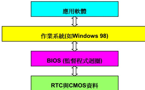
在 BIOS 程式中有一個程式迴圈不斷地紀錄時間與日期的資料(大約每 0.05 秒循環一次)，在一般的 BIOS 中這個程式迴圈並不會每次去更新 CMOS 的時間資料。因為 CMOS 是一個較慢的裝置，這樣會影響電腦效率。在我們所研發的 BIOS 中使用了 4 位數處理年份，然後作業系統與應用程式就會取得正確的日期與時間的資料。所以使用我們的產品 Y2K 的問題是不存在的(已通過 NSTL 測試)，但有些 Y2K 測試程式如 Chekit 98 却直接去讀取 RTC/CMOS 資料，所以請注意**這個主機板僅使用硬體來防護 Y2K 的問題。**
