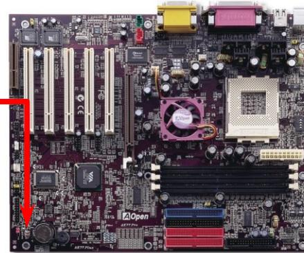
**Warnung:** Installieren oder entnehmen Sie DIMM-Module nicht, während dieses LED aufleuchtet.
