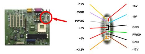
Aviso: Para ATX sistema, hay siempre un corriente listo en este placa madre. Asegura que separar el cable de ATX fuente desde el ATX conector si agregar o borrar cualquier CPU, DIMM, PCI y tarjeta AGP. De otra manera, puede dañar los componentes gravemente.
