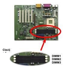
Consejo: El Chipset de nueva generación falta un buffer de la memoria para establecer superior actuación de capabilidad impulsivo. Asi la cantidad del chip DRAM es muy importante en el eficiencia de la memoria. Cuando no el sistema puede contar la cantidad del chip en cada DIMM, debe contarla uno mismo. El sencillo regla es: Por inspección visual, utilizar DIMMs que tener menos de 16 chipes.
