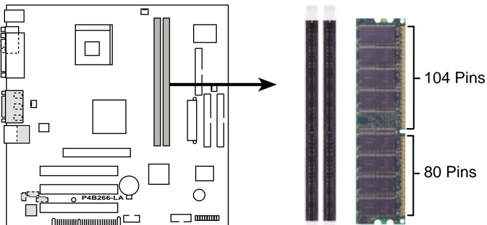
**P4B266-LA 184-Pin DDR DIMM Sockets**
