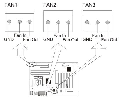
FAN1 : CPU FAN CONNECTOR.FAN2 : For SYSTEM COOL FAN CONNECTOR.FAN3 : For SYSTEM COOL FAN CONNECTOR.
