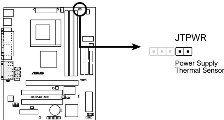
**CUV4X-ME Thermal Sensor Connector**
