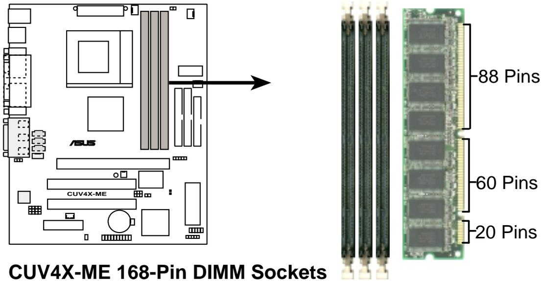
**CUV4X-ME 168-Pin DIMM Sockets**
