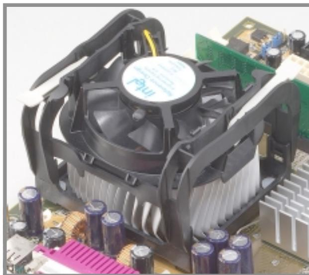
Figura 2-11 Ventilador y Mecanismo de Retención Instalados y Asegurados
