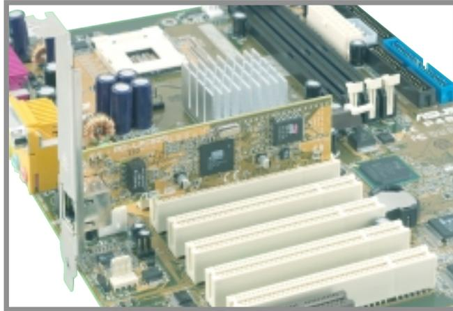
Abbildung 2-18 Installierte PCI-Karte
