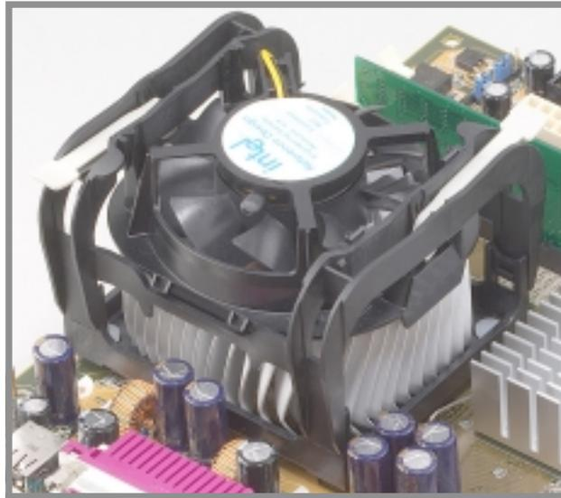
Abbildung 2-11 Lüfter und Haltemechanismus installiert und verriegelt
