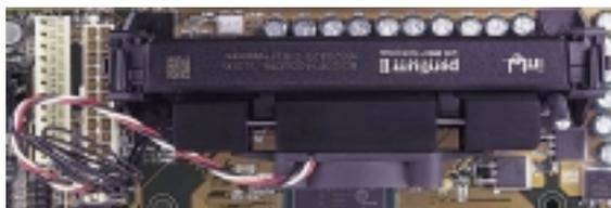
上覆散熱片與風扇、安裝在單邊接觸 CPU 插槽中的 SECC 包裝 Pentium® II 處理器（俯視圖）
