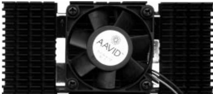
Der AAVID-Kühlkörper mit Ventilator wird ähnlich installiert wie ein Kühlkörper ohne Ventilator. Die obere Leiste der Kühlkörperhalterung kann wegen des Ventilators nicht genutzt werden. Sie ist trotzdem im Lieferumfang der Platine enthalten, für den Fall, daß Sie einen anderen Kühlkörper nutzen wollen.
