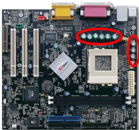
高速度の CPU (新しい Pentium III, またはオーバークロック時等)でのシステム安定性を高めるのに、CPU コア電圧の電源回路をチェックするのは重要です。代表的な CPU コア電圧は 2.0V です。優良な設計では電圧が 1.860V と 2.140V の間になるよう制御されます。つまり変動幅は 280mV 以内ということです。下図はデジタルストレージスコープで測定された電圧変動です。これは電流が最大値 18A の時でも電圧変動が 143mV であることを示しています。
