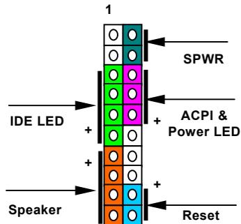
電源 LED、スピーカー、リセットスイッチのコネクタをそれぞれ対応するピンに差してください。BIOS セットアップで **Power Management Setup > ACPI Suspend Type** の項目をオンにした場合は、ACPI 及び電源の LED がサスペンドモード中に点滅します。
