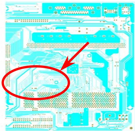
高周波時の操作、特にオーバークロックの場合においては、チップセットと CPU の安定動作を決定付ける最も重要な要素となるのはレイアウトです。このマザーボードでは”周波数分離ウォール (Frequency Isolation Wall) ”と呼ばれる AOpen 独自の設計が採用されています。マザーボードの各主要領域を、動作時の各周波数が同じか類似している範囲に区分けすることで、互いの動作やモードのクロストークや干渉が生じにくくなっています。トレース長および経路は注意深く計算される必要があります。例えばクロックのトレースは同一長となるよう(必ずしも最短ではない)にすることで、クロックスキューは数ピコ秒( $1/10^{12}$  Sec)以内に抑えられています。
