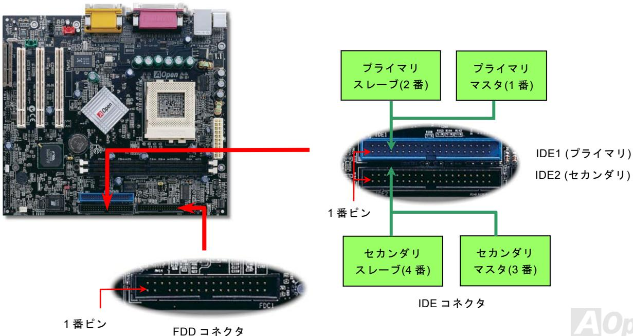
IDE1 はプライマリチャンネル、IDE2 はセカンダリチャンネルとも呼ばれます。各チャンネルは 2 個の IDE デバイスが接続できますので、合計 4 個のデバイスが使用可能です。これらを協調させるには、各チャンネル上の 2 個のデバイスをマスタおよびスレーブモードに指定する必要があります。ハードディスクまたは CDROM のいずれでも接続可能です。モードがマスタかスレーブかは IDE デバイスのジャンパー設定に依存しますので、接続するハードディスクまたは CDROM のマニュアルをご覧ください。
