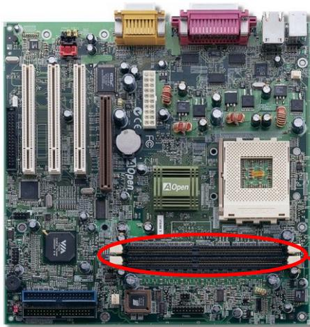
**Warnung:** Das MK77 unterstützt DDR SDRAM. Bitte stecken Sie keine herkömmlichen SDRAM-Module in die DDR SDRAM-Steckplätze, da Sie die Speichersteckplätze oder die Speichermodule ansonsten schwer beschädigen könnten.
