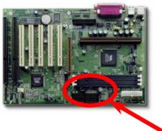
Diese Brücke wird dazu verwendet, die Verbindung zwischen PCI und [FSB](#)-Takt zu spezifizieren. Im allgemeinen empfehlen wir die Standardeinstellung, sofern Sie nicht übertakten.
