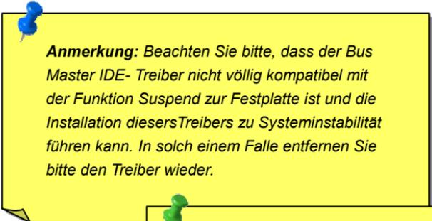
**Anmerkung:** Beachten Sie bitte, dass der Bus Master IDE- Treiber nicht völlig kompatibel mit der Funktion Suspend zur Festplatte ist und die Installation dieses Treibers zu Systeminstabilität führen kann. In solch einem Falle entfernen Sie bitte den Treiber wieder.
