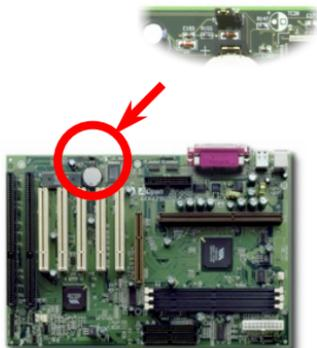
Sie können das CMOS löschen oder die Systemvoreinstellungen wiederherstellen. Zum Löschen des CMOS gehen Sie wie folgt vor.
