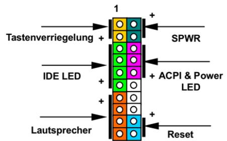
Schließen Sie die Anschlüsse für Netz-LED, Tastenverriegelung, Lautsprecher und Resetschalter an die entsprechenden Pole an. Falls Sie das ["Suspend Mode"](#) -Symbol im BIOS-Setup aktivieren, leuchtet das ACPI & Netz-LED weiter auf, während
