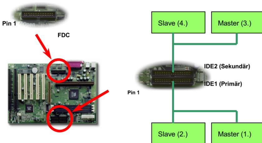
IDE1 wird auch als der primäre Kanal und IDE2 der sekundäre Kanal genannt. Jeder Kanal unterstützt zwei IDE-Geräte; insgesamt vier Geräte. Um zusammenarbeiten zu können, müssen die beiden Geräte auf jedem Kanal auf **Master-** bzw. **Slave-**Modus gestellt werden. Beide können auf Festplatte oder CDROM gestellt werden. Die Einstellung als Master- oder Slave-Modus hängt von der Brücke auf Ihrem IDE-Gerät ab, schauen Sie also bitte im Handbuch Ihrer Festplatte bzw. CDROM nach.
