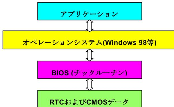
BIOS にはティックルーチン (約 50m 秒毎に実行) があり、日時情報を更新します。CMOS の動作速度はとても遅くシステム性能を
