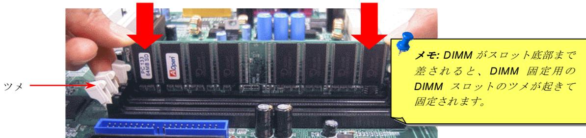
3. 他の DIMM モジュールも同様にステップ 2 の方法を繰り返してインストールします。
