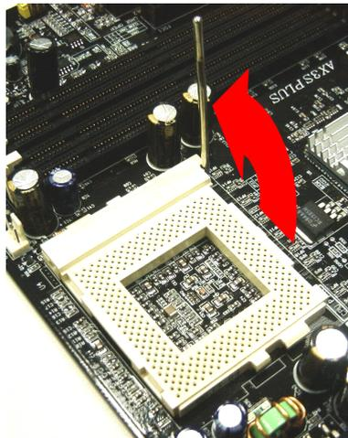
2. ソケットの 1 番ピンの位置および CPU 上部の面取り部を確認します。1 番ピンおよび面取り部を合わせます。この方向で CPU をソケットに差し込みます。
