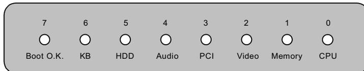
システム起動時にエラーが生じると 8 個の内その段階に応じた LED が点灯します。7 番 LED (最後に点灯する LED) が点灯すれば、システムは正常に起動したことを表します。
