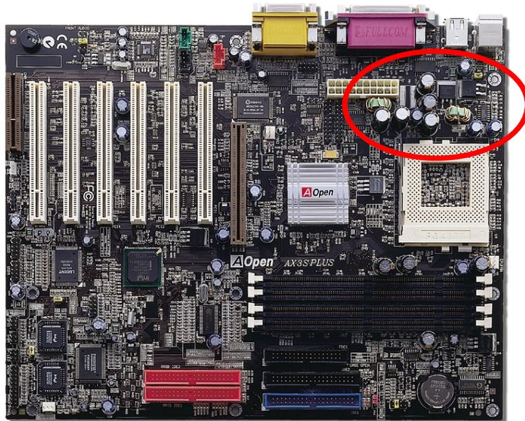
CPU コア電圧の電源回路は高速度の CPU (新しい Pentium III, またはオーバークロック等)でのシステム安定性を高めるのに重要な要素です。代表的な CPU コア電圧は 2.0V なので、優良な設計では電圧が 1.860V と 2.140V の間になるよう制御されます。つまり変動幅は 280mV 以内ということです。下図はデジタルストレージスコープで測定された電圧変動です。これは電流が最大値 18A の時でも電圧変動が 143mV であることを示しています。
