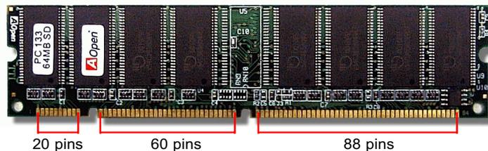
2. DIMM ソケットにモジュールを両手でまっすぐ下方に DIMM モジュールが止まるまで差し込みます。
