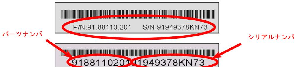
P/N: 91.88110.201 がパーツナンバーで、S/N: 91949378KN73 がシリアルナンバーです。
