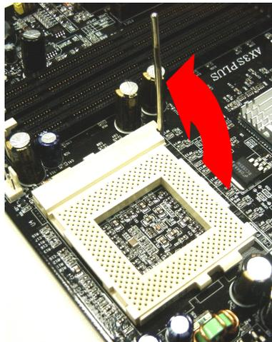
2. ソケットの 1 番ピンと CPU 上部の面取り部を確認します。1 番ピンおよび面取り部を合わせます。この方向で CPU をソケットに差し込みます。
