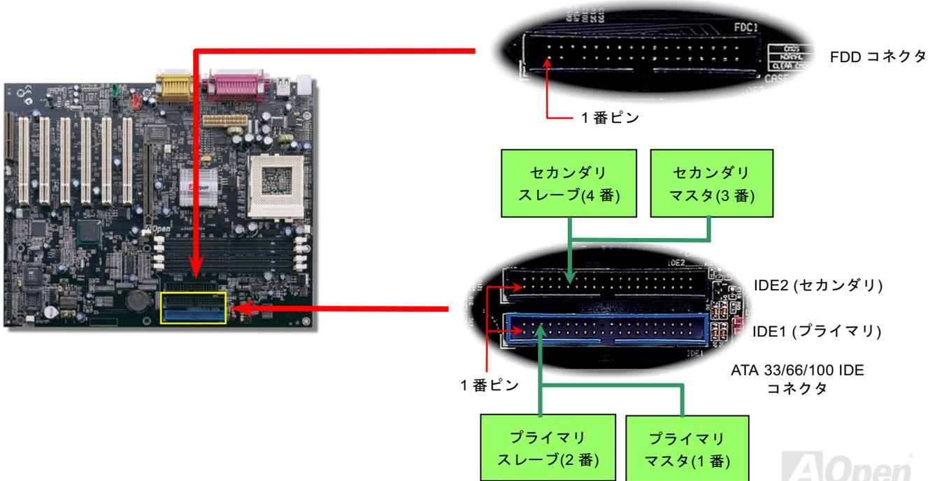
IDE1 はプライマリチャンネル、IDE2 はセカンダリチャンネルとも呼ばれます。各チャンネルは 2 個の IDE デバイスが接続できますので、合計 4 個のデバイスが使用可能です。これらを協調させるには、各チャンネル上の 2 個のデバイスをマスタおよびスレーブモードに指定する必要があります。ハードディスクまたは CDRROM のいずれでも接続可能です。モードがマスタかスレーブかは IDE デバイスのジャンパー設定に依存しますので、接続するハードディスクまたは CDRROM のマニュアルをご覧ください。
