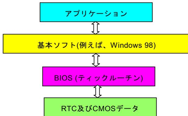
BIOS にはティックルーチン (約 50m 秒毎に実行) があり、日時情報を更新します。CMOS の動作速度はとても遅くシステム性能を落としますので、一般には BIOS のティックルーチンは毎回 CMOS を更新するわけではありません。AOpen BIOS のティックルーチンは、アプリケーション及び基本ソフトが日時情報の取得ルールに従う限り、年コードに 4 桁を使用します。それで Y2K 問題 (NSTL テストプログラム等) はもはやありません。しかしながら残念なことにテストプログラム (Checkit 98 等) によっては
