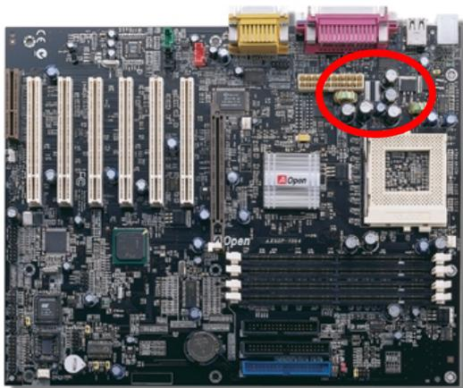
高速度の CPU (新しい Pentium III, またはオーバークロック時等)でのシステム安定性を高めるのに、CPU コア電圧の電源回路をチェックするのは重要です。代表的な CPU コア電圧は 2.0V です、優良な設計では電圧が 1.860V と 2.140V の間になるよう制御されます。つまり変動幅は 280mV 以内ということです。下図はデジタルストレージスコープで測定された電圧変動です。これは電流が最大値 18A の時でも電圧変動が 143mV であることを示しています。
