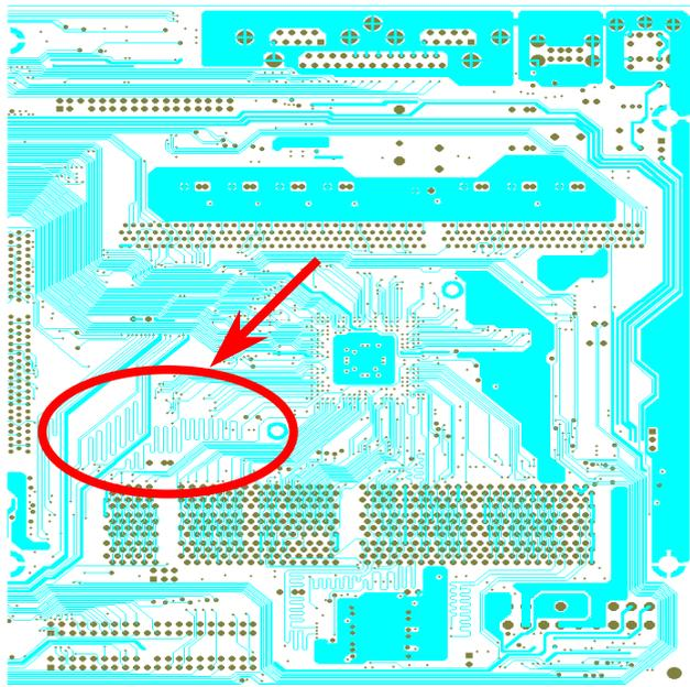
高周波時の操作、特にオーバークロックの場合においては、チップセットとCPUの安定動作を決定付ける最も重要な要素となるのはレイアウトです。このマザーボードでは「周波数分離ウォール (Frequency Isolation Wall)」と呼ばれる AOpen 独自の設計が採用されています。マザーボードの各主要領域を、動作時の各周波数が同じか類似している範囲に区分けすることで、互いの動作やモードのクロストークや干渉が生じにくいようになっています。トレース長および経路は注意深く計算される必要があります。例えばクロックのトレースは同一長となるよう(必ずしも最短ではない)にすることで、クロックスキューは数ピコ秒( $1/10^{12}$  Sec)以内に抑えられています。
