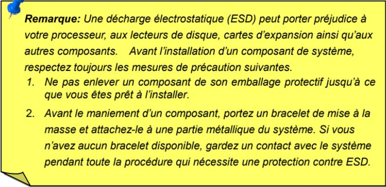
**Remarque:** Une décharge électrostatique (ESD) peut porter préjudice à votre processeur, aux lecteurs de disque, cartes d'expansion ainsi qu'aux autres composants. Avant l'installation d'un composant de système, respectez toujours les mesures de précaution suivantes.
