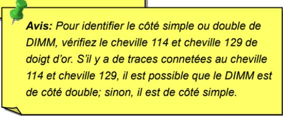
**Avis:** Pour identifier le côté simple ou double de DIMM, vérifiez la cheville 114 et cheville 129 de doigt d'or. S'il y a de traces connectées au cheville 114 et cheville 129, il est possible que le DIMM est de côté double; sinon, il est de côté simple.
