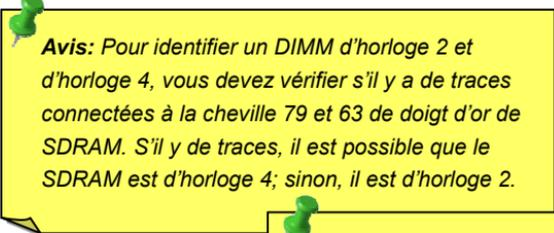
**Avis:** Pour identifier un DIMM d'horloge 2 et d'horloge 4, vous devez vérifier s'il y a de traces connectées à la cheville 79 et 63 de doigt d'or de SDRAM. S'il y a de traces, il est possible que le SDRAM est d'horloge 4; sinon, il est d'horloge 2.
