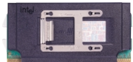
不正確安裝之固定夾具圖例
