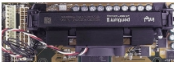
上覆散熱片與風扇、安裝在單邊接觸 CPU 插槽中的 SECC 包裝 Pentium® II 處理器（俯視圖）
